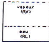
Figure 1. Dans une enceinte close, à une température constante de 25°C, à l'équilibre, la pression de vapeur se stabilise à une valeur constante.
