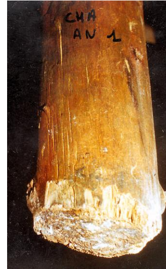
Extrémité inférieure de pieu aplatie pour en réduire la surface afin de faciliter son enfoncement par thixotropie
